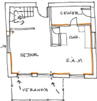
Les fenêtres datant des années 80 n'étaient pas aussi performantes qu'aujourd'hui, mais dans ce cas la cause de l'inconfort n'est pas toujours la fenêtre. Les murs et le sol n'étant pas isolés, la priorité des travaux serait de **commencer par une isolation des murs** et de calfeutrer les **ponts thermiques** au niveau du raccord mur-toiture.
