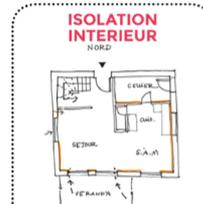
Les fenêtres datant des années 80 n'étaient pas aussi performantes qu'aujourd'hui, mais dans ce cas, ça n'est probablement pas les fenêtres la cause de l'inconfort. Les murs et le sol n'étant pas isolés, la priorité des travaux serait de commencer par une isolation des murs et de caletter les ponts thermiques près de la panne sablière (basse).
